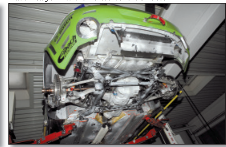
Schnelle Fahrwerksvermessung mittels Photogrammetrie zur Konstruktion und Simulation
